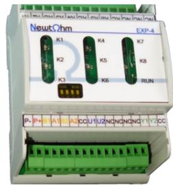
Modulo di espansione ingressi/uscite con protocollo Modbus RTU per barra DIN (4 moduli). Il modulo è dotato di ingressi universali configurabili via software. La flessibilità di comunicazione è garantita dalla dotazione di 2 porte modbus RTU
