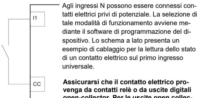
Agli ingressi N possono essere connessi contatti elettrici privi di potenziale. La selezione di tale modalità di funzionamento avviene mediante il software di programmazione del dispositivo. Lo schema a lato presenta un esempio di cablaggio per la lettura dello stato di un contatto elettrico sul primo ingresso universale.
