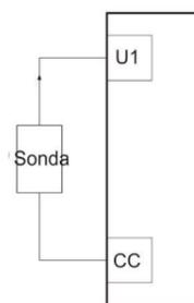
Agli ingressi universali U del dispositivo possono essere connesse sonde di temperatura NTC 10K, Pt1000, Ni1000 o sensori KTY81. La programmazione dell'ingresso deve essere selezionata attraverso il software di programmazione VisiPROG
