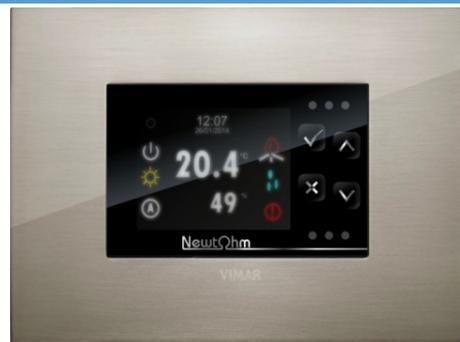
Regolatore digitale compatto da incasso in box formato 503 o barra DIN con display grafico 160x128 punti e sonda di temperatura (PLT) o temperatura/umidità (PLTH). Il regolatore è in grado di svolgere semplici funzioni HVAC con logica pre-programmata.
