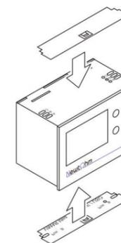
Inserire il dispositivo nel supporto placca della serie civile utilizzata e completare l’installazione.
