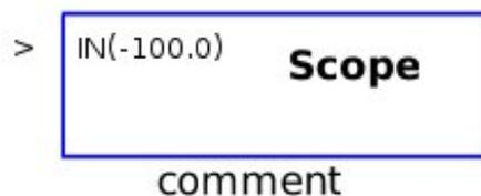
Il blocco consente di visualizzare su diagramma temporale il valore di una determinata variabile. Sotto è riportato un esempio di un grafico realizzato dal programma.
