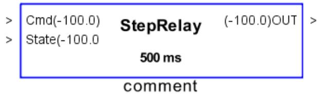
Il blocco implementa la funzione di gestione per relè di tipo passo passo: l'ingresso Cmd indica lo stato che si vuole imporre in uscita mentre l'ingresso State consente al blocco di controllare se l'uscita ha il valore desiderato; in caso contrario l'uscita sarà comandata con impulsi della durata specificata nel campo **Step Time** della finestra delle proprietà fino a che State non assume il valore desiderato.
