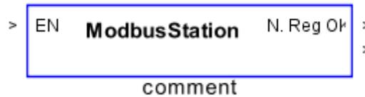
Il blocco consente di integrare nella logica di regolazione una o più variabili d'ingresso prelevate da un dispositivo ModBUS RTU *slave* connesso al regolatore DDC e di trasmettere informazioni dalla logica di regolazione verso un dispositivo ModBUS RTU *slave* connesso al regolatore DDC. E' possibile modificare la stringa di commento.
