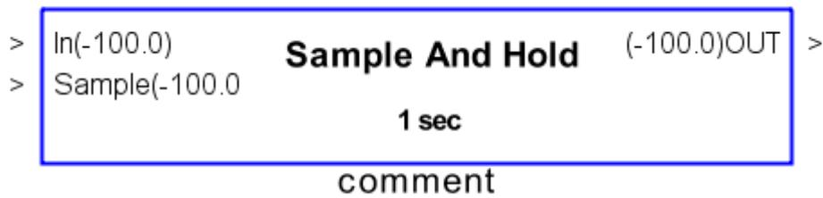
Il blocco consente di campionare l'ingresso e di riproporlo in uscita ad intervalli regolari. L'ingresso **Sample** consente di campionare l'ingresso su intervalli di tempo desiderati: quando Sample assume il valore 0, il blocco è trasparente; l'ingresso viene riportato immediatamente in uscita. Se Sample è diverso da 0 il blocco campiona ad intervalli di tempo regolari (Secondi, Minuti, Ore) in base al valore inserito.
