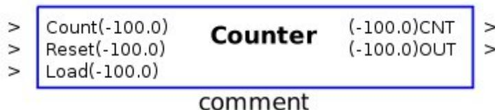
Il blocco implementa la funzione di conteggio sui fronti di salita della variabile **Count** riportando il valore in uscita (**CNT**), contemporaneamente l'uscita **OUT** passa dal valore 0 a 1 quando **CNT = Amount**. Il conteggio può essere azzerato mediante l'ingresso **Reset** o assegnare nel contatore un valore iniziale indicato dal **Load**.
