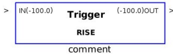
Il blocco consente di ottenere in uscita un impulso di durata pari ad un ciclo di scansione se l'ingresso presenta un fronte di salita (RISE) o di discesa (FALL). Il modo di funzionamento è selezionabile mediante la finestra proprietà.
