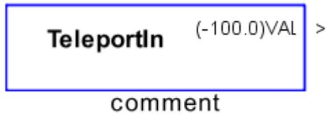
Il blocco consente di leggere il valore dell'uscita di un altro blocco, o di un registro interno, senza fisicamente eseguire una connessione grafica tra i due; in pratica rappresenta una "scorciatoia" per l'acquisizione di un'informazione presente in un altro punto del programma. Attraverso la finestra delle proprietà è possibile indicare quale registro si intende leggere.
