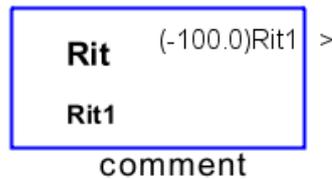
Questo blocco driver consente di leggere lo stato del ritaratore integrato in alcuni DDC. La misura è scalata attraverso l'impostazione di un valore minimo ed un valore massimo modificabile dalle proprietà del blocco. E' inoltre possibile personalizzare la stringa di commento.
