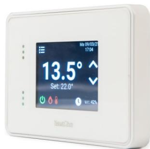
Regolatore digitale liberamente programmabile per installazione su scatola 503 con display grafico 320x240 punti dotato di touch screen e sonde temperatura/umidità e CO2/VOC (Versione CV). Il regolatore è in grado di svolgere articolate funzioni HVAC (es. gestione pannelli radianti con deumidificazione e VMC).
