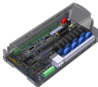
Regolatore digitale compatto in contenitore 9 moduli DIN, liberamente programmabili e multi porta Modbus RTU, in grado di svolgere articolate funzioni HVAC. Il modulo è dotato di ingressi universali configurabili via software e relè di potenza per creare qualsiasi applicazione complessa di automazione e supervisione SCADA. La scheda può essere equipaggiata di display grafico 128x64 punti.
