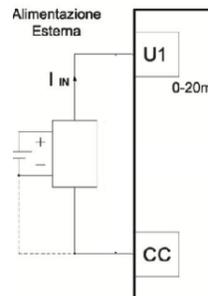
**Per un collegamento con trasduttori con uscita in corrente: impostare correttamente la tipologia di sonda nel programma prima di collegare una sonda in corrente.**
