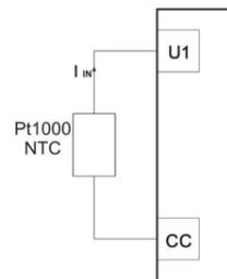
Agli ingressi universali del dispositivo possono essere connesse sonde di temperatura Pt1000 e NTC. La programmazione dell'ingresso per la lettura di sonde di temperature Pt1000 e NTC deve essere selezionata attraverso il software di programmazione VISIPROG.
