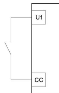
Agli ingressi U possono essere connessi contatti elettrici privi di potenziale. La selezione di tale modalità di funzionamento avviene mediante il software di programmazione del dispositivo. Lo schema a lato presenta un esempio di cablaggio per la lettura dello stato di un contatto elettrico sul primo ingresso universale.
