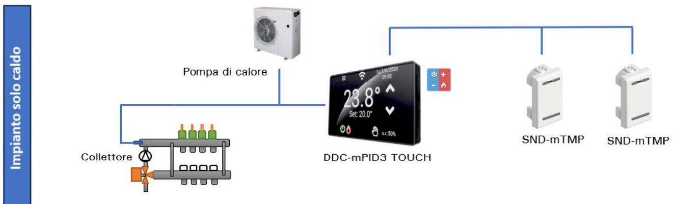
Soluzione compatta indicata per applicazioni monocollettore fino a 3 zone con regolazione solo in caldo.
